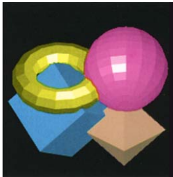
Рис. 22. Сцена с несколькими плавно затененными объектами. Слева — ступенчатый вариант. Справа — для сглаживания сцены использовался буфер накопления; рендеринг выполнялся несколько раз, и каждый раз осуществлялось «дрожание» менее чем на пиксел, затем изображения собирались вместе и делалось усреднение. См. главу 10.
