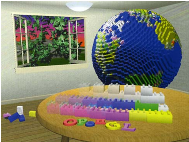
Рис. 7. Сцена, на которой один из объектов показан в размытии. Здесь использовался буфер накопления для создания последовательности изображений; это и привело к размытию движущегося объекта. См. главу 10.
