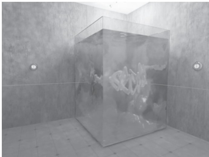
Рис. 1.1. Создание модели стереолитографическим способом
