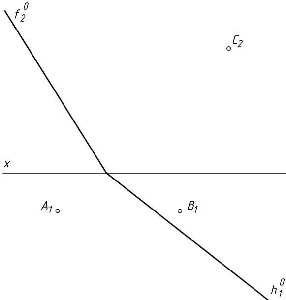
**Задача 1.3.25.** Назвать положение плоскости  $\alpha (h^0 \cap f^0)$  и построить проекции ее  $\triangle ABC$ .
