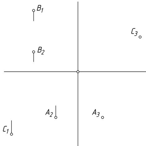
**Задача 1.3.9.** Прямая линия  $b$  задана следами:  $V(V_1 V_2) = b \cap \Pi_2$ ,  $H(H_2 H_3) = b \cap \Pi_1$ . Построить три проекции прямой  $b$ , ее профильного следа  $W$ . Обозначить оси.
