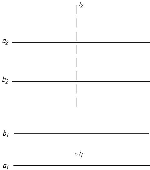
**Задача 1.3.23.** Построить следы плоскости  $\alpha (a \parallel b)$ , вторую проекцию прямой линии  $l$  и точки  $D$  этой плоскости.
