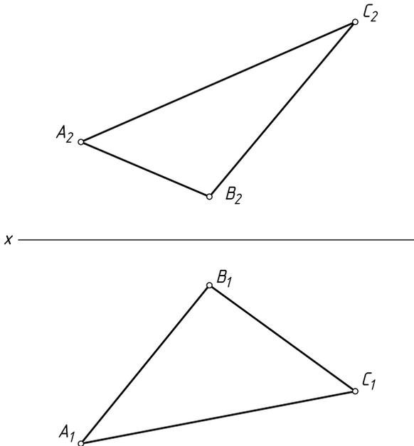
**Задача 1.3.33.** Построить следы плоскости  $\alpha (a \parallel b)$  и ее линии уровня на высоте 15 мм и с глубиной 20 мм. Показать точку  $D = h \cap f$ .
