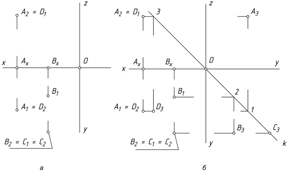
Рис. 1.15. Построение профильных проекций заданных точек
