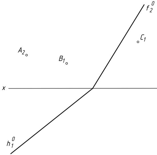
**Задача 1.3.36.** Определить положение точек относительно плоскости  $\alpha (a \cap b)$ . Указать множество точек плоскости с равными глубиной и высотой.
