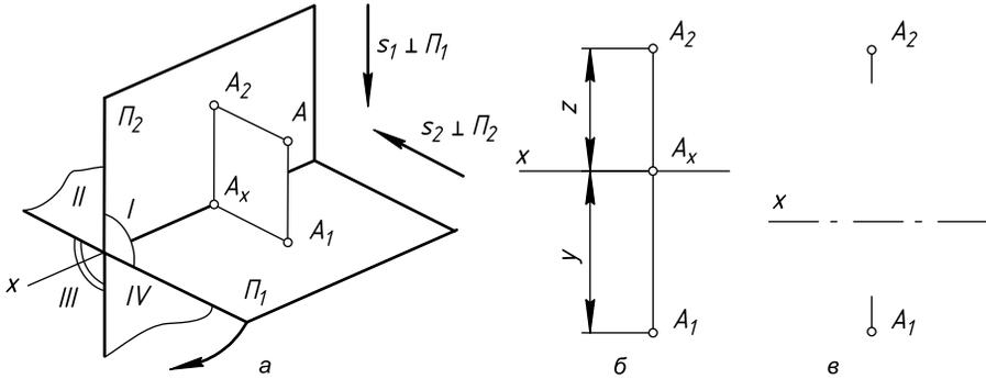
Рис. 1.1. Образование двухкартинного чертежа объекта
