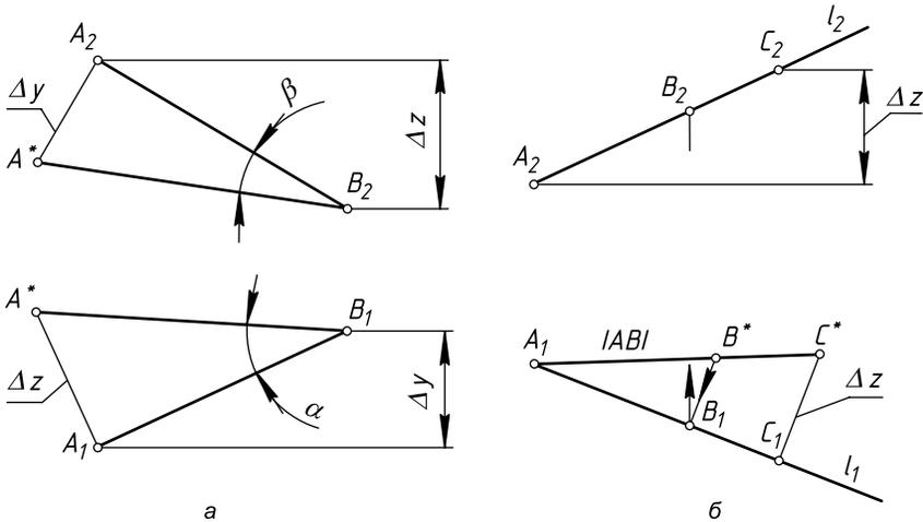
Рис. 1.8. Определение длины и углов наклона отрезка
