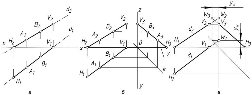
Рис. 1.5. Чертеж и следы прямой общего положения
