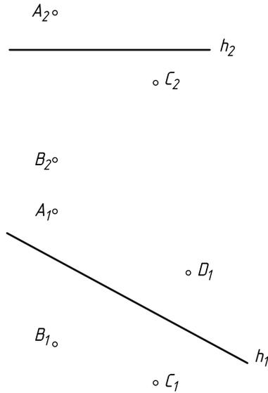
**Задача 1.3.14.** На прямой  $[AB]$  построить отрезки  $AC$ :  $CB = 3 : 2$ , определить угол наклона этой линии к фронтальной плоскости проекций и длину  $|AC|$ .
