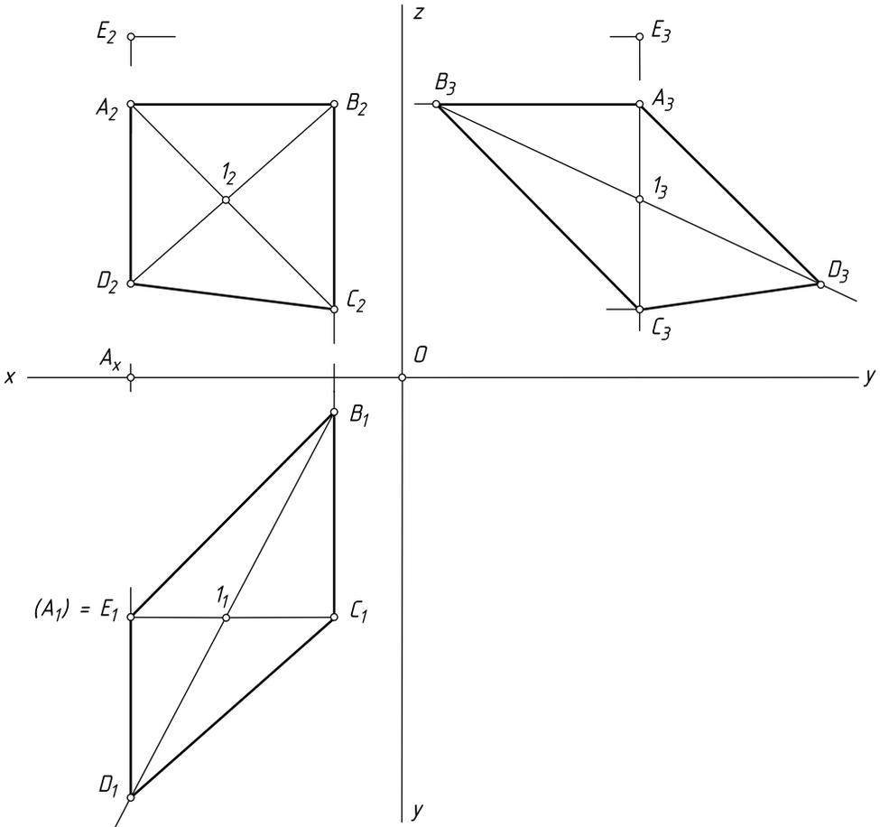
Рис. 1.14. Относительное положение точки и плоскости
