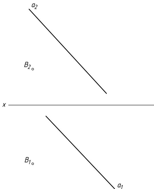
**Задача 1.3.30.** В плоскости  $\Delta ABC$  построить линии уровня на высоте 25 мм и глубине 30 мм.
