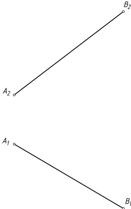
**Задача 1.3.15.** Разделить отрезок  $[AB]$  в отношении  $AC : CB = 1 : 4$  и определить его угол наклона к горизонтальной плоскости проекций и длину  $|CB|$ .
