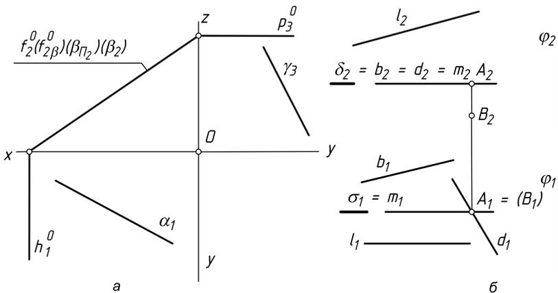
Рис. 1.13. Плоскости частного положения
