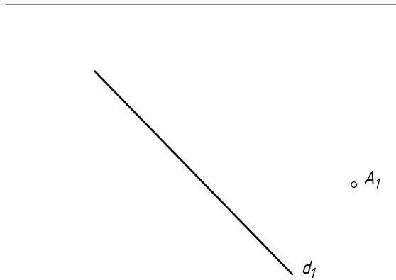
**Задача 1.3.18.** Через точку  $A$  провести плоскость  $\alpha (h \cap i)$ , где  $i \perp \Pi_1$ , а угол  $\beta = h \wedge \Pi_2 = 45^\circ$ . Назвать положение плоскости  $\alpha$ , построить и обозначить ее следы, построить прямую линию  $c \parallel \alpha$  на расстоянии 15 мм от нее.
