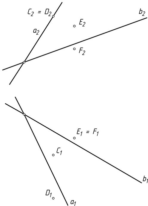
**Задача 1.3.37.** Построить изображения  $\triangle ABC$  и найти следы его плоскости. Указать положения его вершин по квадратам и обвести видимую относительно плоскостей проекций часть треугольника основной линией.
