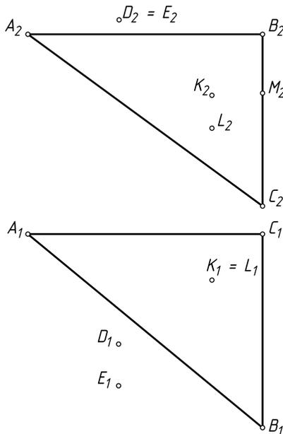
**Задача 1.3.35.** Построить  $\triangle ABC$  плоскости  $\alpha (h^0 \cap f^0)$  и обвести его видимую относительно плоскостей проекций часть основной линии. В каких четвертях находятся его вершины?
