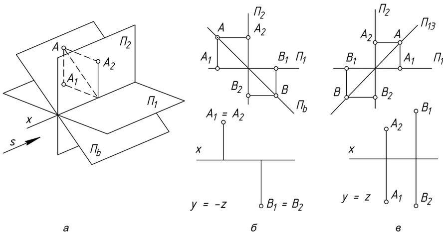
Рис. 1.3. Частные случаи чертежа точки
