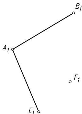
**Задача 1.3.5.** Построить фронтальную и профильную проекции плоского пятиугольника. Назвать положение его плоскости.
