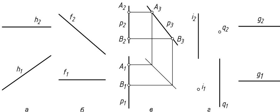
Рис. 1.6. Чертежи прямых линий частного положения
