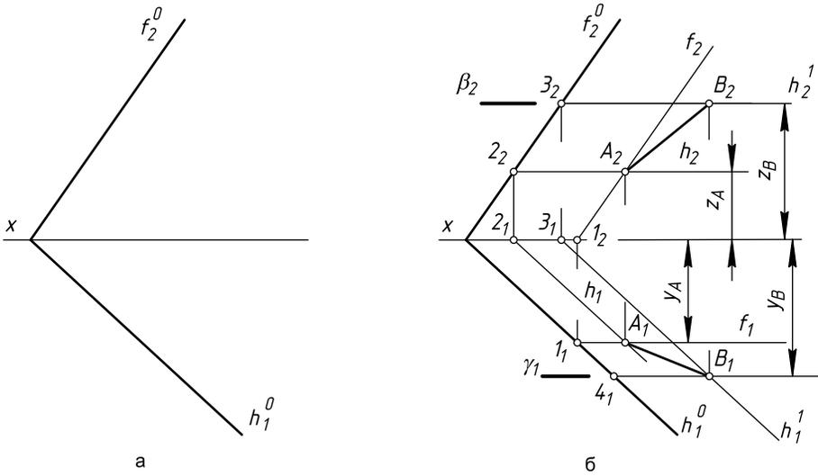
Рис. 1.16. Построение точек плоскости по заданной координате
