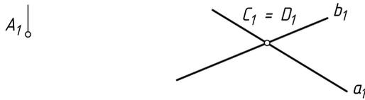
**Задача 1.3.22.** Назвать положение плоскости  $\alpha$  ( $a \parallel b$ ) и прямой линии  $l(i_1 i_2)$ . Определить их общий элемент и относительную видимость.
