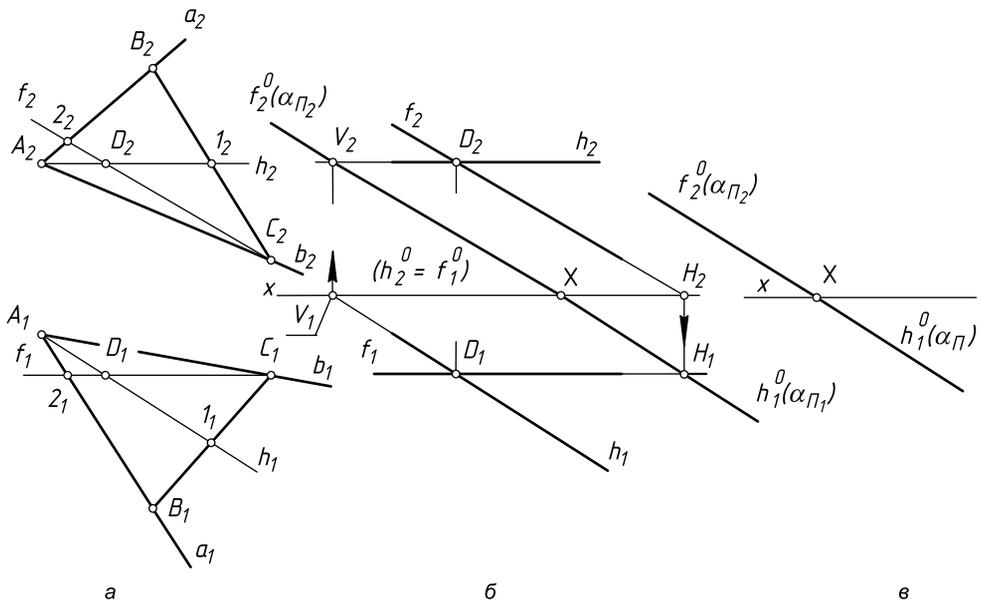
Рис. 1.12. Линии уровня и следы плоскости общего положения
