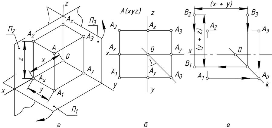
Рис. 1.4. Образование трехкартинного чертежа объекта
