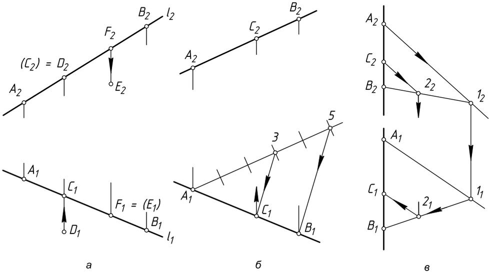
Рис. 1.7. Свойства инцидентности и пропорциональности отрезков
