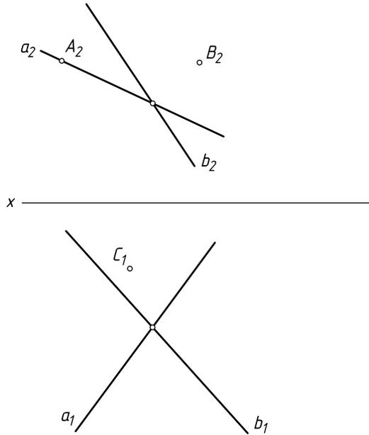
**Задача 1.3.28.** Построить отрезок  $[CE]$  плоскости  $\alpha (a \cap b)$  и прямую линию  $d \parallel b$ , проходящую через точку  $A(-15, 20)$ . Определить положение этой прямой относительно плоскости  $\alpha$  (выше, ниже, перед или за плоскостью).
