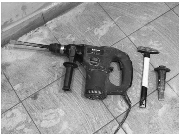
Рис. 1.2. Инструмент для сбивания старой плитки: перфоратор, молоток, зубило
