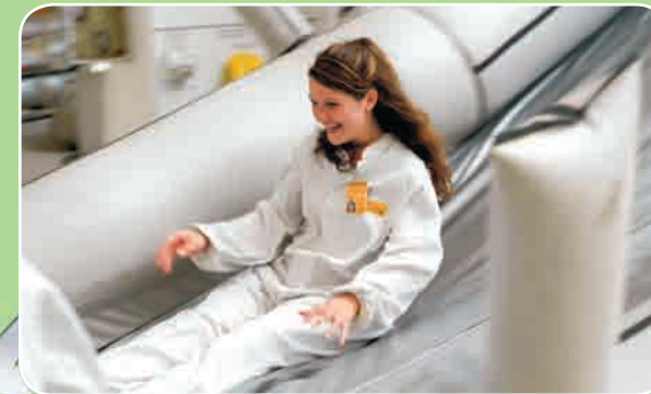
Бортпроводница тестирует аварийный трап.
