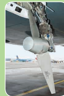
Аварийная авиационная турбина активизируется при отказе двигателей и снабжает важнейшие системы на борту электричеством.
