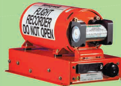
Бортовой самописец записывает много различных измерений, например высоту полёта и скорость. Он так надёжно запакован, что остаётся в целости даже после крушения самолёта, и с его данными можно работать.
