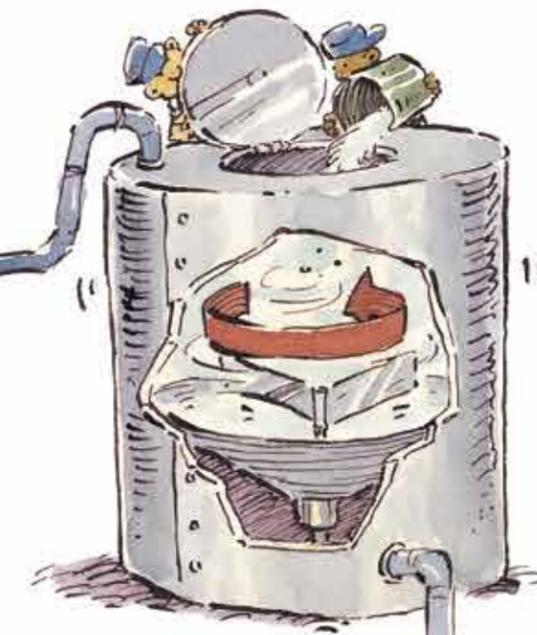
**3.** Смесь по трубам доставляют в бак для пастеризации, где ее нагревают до 82 °С, чтобы убить бактерии.
