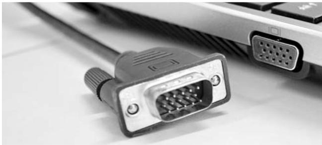
**Рис. 1.3.** Разъем в корпусе ноутбука и шнур для подключения настольного монитора
