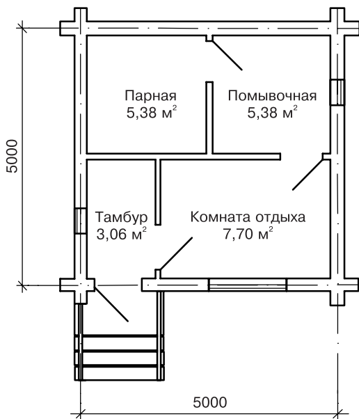
Рис. 1.2. План одноэтажной деревянной бани
