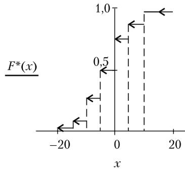
**Рис. 3.** Статистическая функция распределения амплитуд углов отклонений корабля
