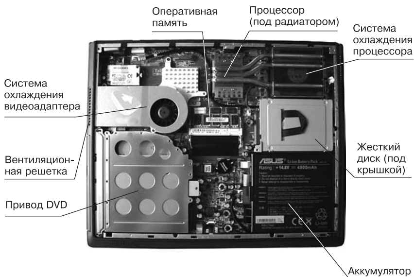
Рис. 1.3. Ноутбук со снятой нижней крышкой
