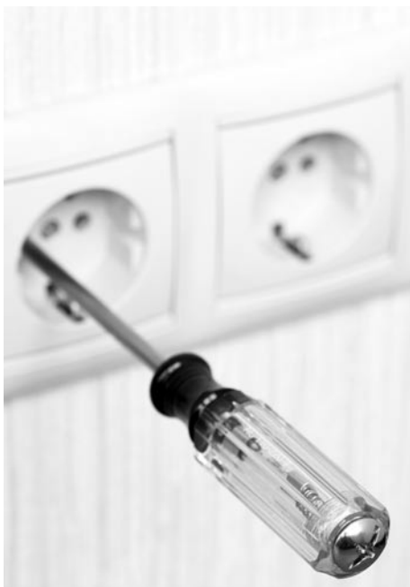
Рис. 1.8. Фазный индикатор, являющийся одновременно плосколицевой отверткой
