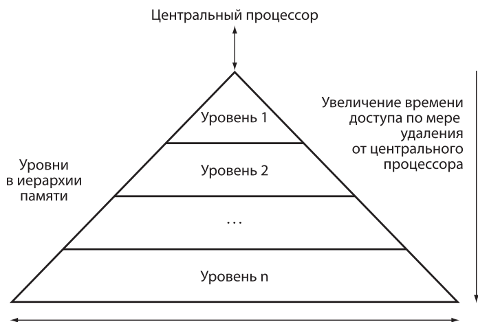
Рис. 5.3. На этой схеме показана структура иерархии памяти: по мере увеличения расстояния от процессора растет и объем. Эта структура с соответствующими рабочими механизмами позволяет процессору иметь время доступа, которое определяется главным образом уровнем 1 иерархии, и при этом обладать памятью с объемом, соответствующим уровню n . Воплощение в жизнь этой иллюзии и является темой данной главы. Хотя в нижней части иерархии обычно находится локальный диск, в некоторых системах в качестве следующих уровней иерархии используется магнитная лента или файловый сервер, доступный по локальной сети
