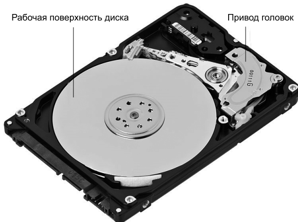
Рис. 12.2. Внешний вид жесткого диска со снятой крышкой корпуса
