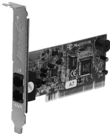
Рис. 1.7. Пример карты расширения — внутренний модем
