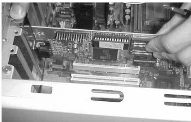
Рис. 1.8. Установка карты расширения в слот на материнской плате
