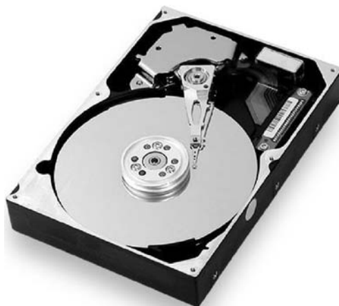
Рис. 1.12. Внутреннее устройство жесткого диска
