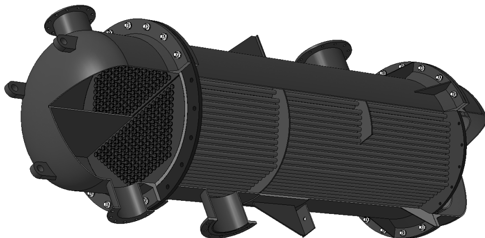
Рис. 1.3. 3D-модель кожухотрубного теплообменного аппарата, созданная в КОМПАС-3D только с помощью твердотельного моделирования
