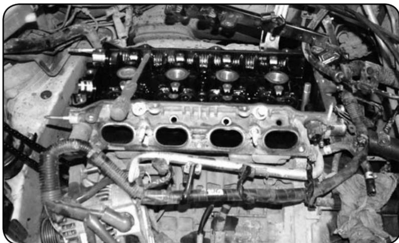
**Рис. 1.2.** Двигатель со снятой головкой блока цилиндров
