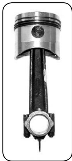
**Рис. 1.3.** Поршень с шатуном
