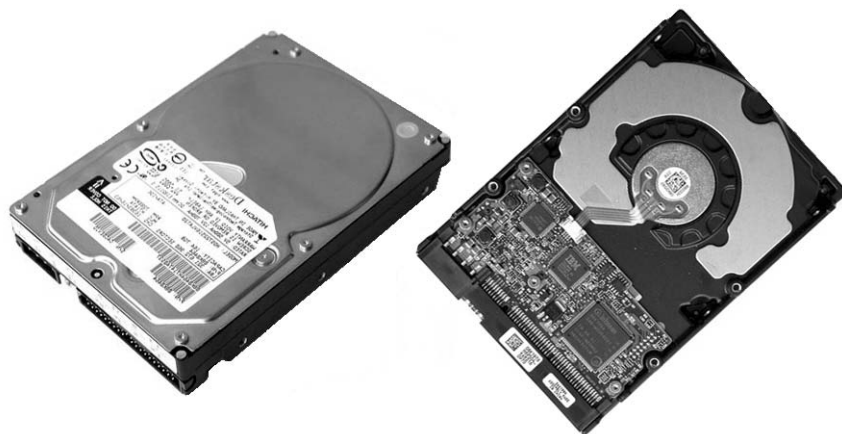
Рис. 1.6. Винчестер: вид сверху и снизу
