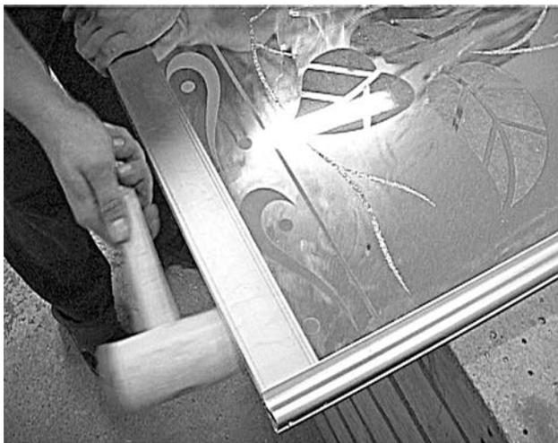
**Рис. 1.5.** Надевание металлического профиля на стеклянную дверь-купе
