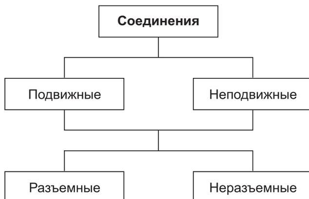
*Подвижными* называют соединения, обеспечивающие относительное перемещение соединяемых частей в процессе работы изделия (под нагрузкой). То есть при этом подразумеваются устройства для преобразования или передачи энергии от одного источника к другому и устройства для преобразования движения.
