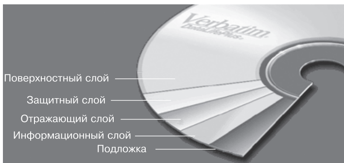
Рис. 1.1. Физическая структура диска CD-R
