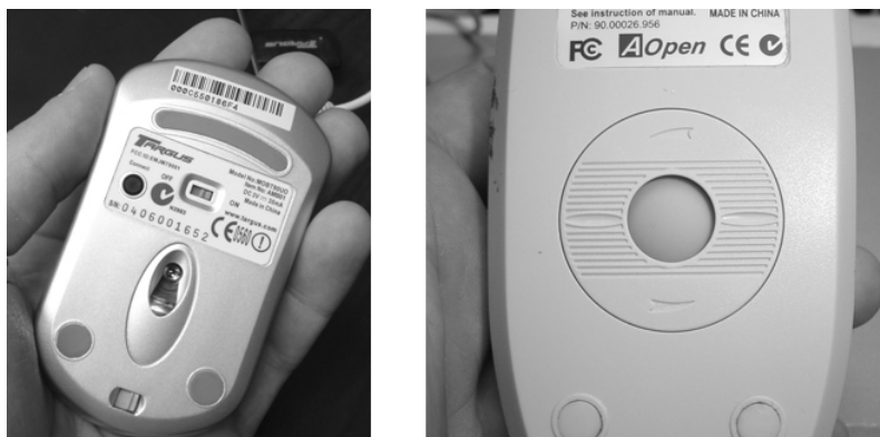
Рис. 4.2. Оптическая (слева) и механическая (справа) мышь (вид снизу)
