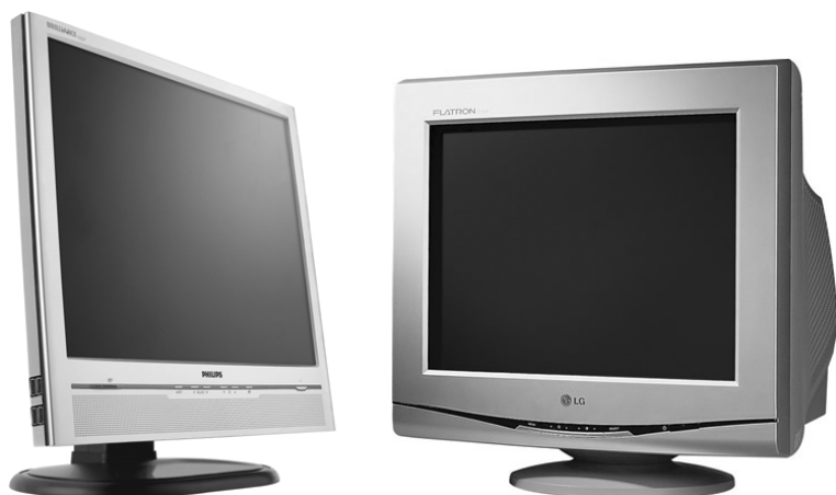
Рис. 2.1. ЖК-монитор (слева) и монитор на основе электронно-лучевой трубки (справа)
